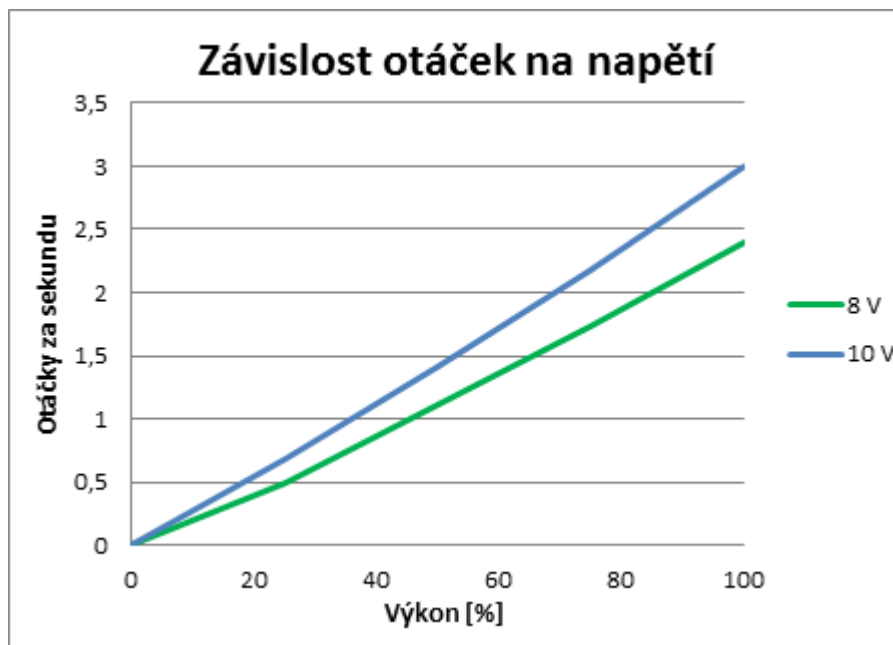
Graf 4-1 Závislost otáček motoru na napětí baterie.
